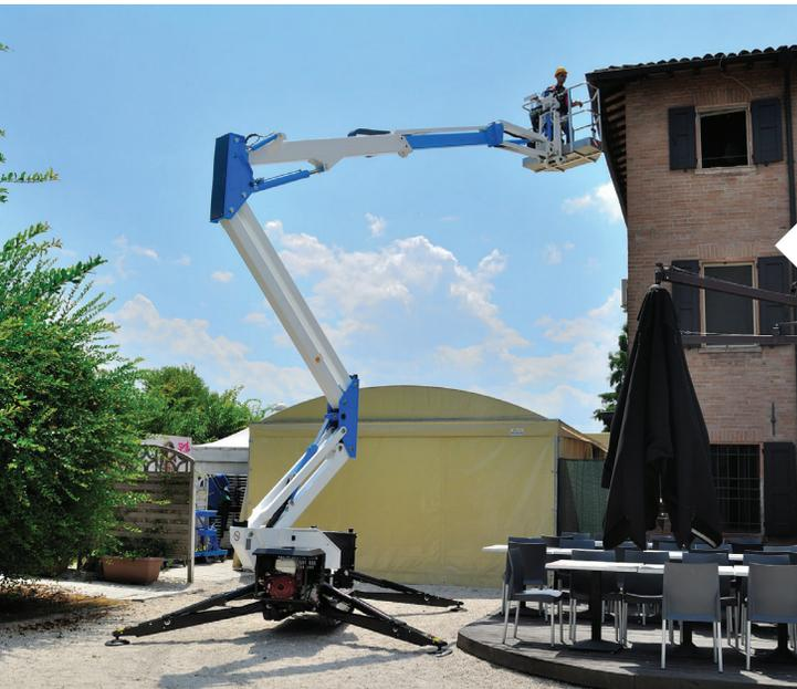
Plataforma de trabalho aéreo tipo lança articulada dotada de um sistema de esteiras capazes de vencer lances de escadas e se deslocar em pisos brutos. Em modo recolhido pode ultrapassar portas de até 80 centímetros. Seu sistema de nivelamento por patolas permite trabalhos em pisos com grandes desníveis ou inclinados. Altura de trabalho de até 21 metros. Esse modelo também é conhecido como plataforma aranha ou “spyder”.
